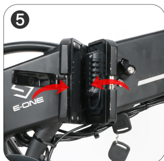
Inserire la chiave nella toppa, girare in senso orario per bloccare la batteria, e poi piegare il telaio.
