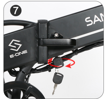
7 Cuando quiera quitar la batería, necesita desbloquear la batería según la dirección primero. Cuando el vehículo está encendido, es necesario girar las dos marchas en sentido contrario a las agujas del reloj para desbloquear
