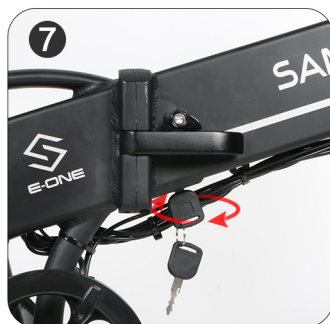
Quando si vuole rimuovere la batteria, è necessario sbloccare la batteria secondo la direzione prima. Quando il veicolo è acceso, è necessario ruotare i due ingranaggi in senso antiorario per sbloccare
