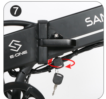
7 Lorsque vous voulez retirer la batterie, vous devez d'abord la déverrouiller en suivant la direction. Lorsque le véhicule est en marche, vous devez faire tourner les deux engrenages dans le sens inverse des aiguilles d'une montre pour déverrouiller.
